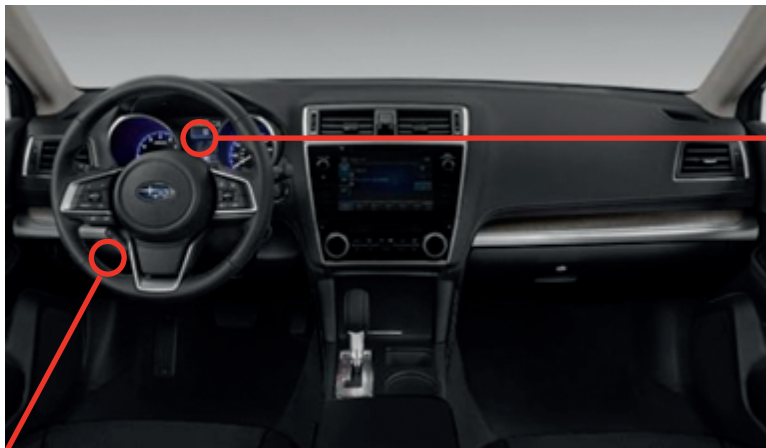
⑤ Keyless access ECU, behind cluster. ECU de télédeverrouillage, derrière l'instrumentation.
