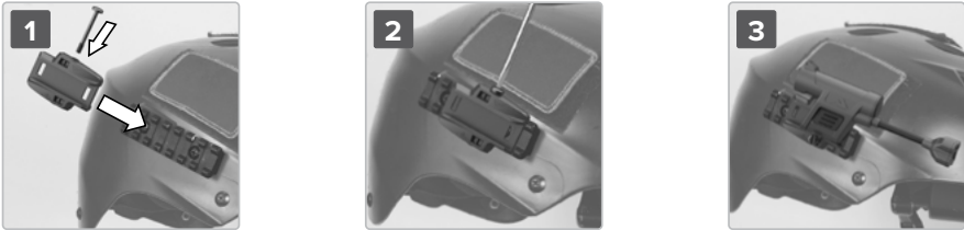
Figura 9 – Montaje sobre riel (ABR)
