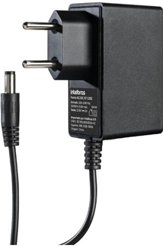
A fonte EF 1202 é projetada para dispositivos 12 V com consumo de até 2 A. Ela possui proteção contra curto-circuito e sobrecarga, prevenindo danos decorrentes de avarias elétricas, e contra sobretensão, para evitar ou minimizar problemas causados por descargas atmosféricas ou manobras da rede de distribuição elétrica. Além disso, possui filtro contra ruídos e interferências na imagem.
