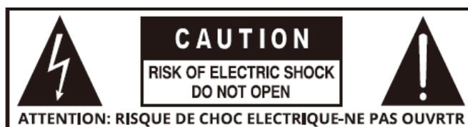
17. Символ молнии со стрелкой внутри треугольника предупреждает пользователя о наличии «опасного напряжения» внутри корпуса изделия, которое может иметь достаточную величину, чтобы создать риск поражения людей электрическим током.
