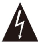
Этот символ предупреждает вас о наличии внутри корпуса неизолированного опасного напряжения, которое может быть достаточным для поражения электрическим током.
