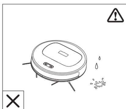
Ne laissez pas le robot fonctionner sur des sols humides.
