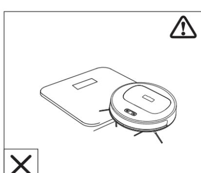
Le robot peut grimper au sommet d'objets d'une hauteur inférieure à 12 mm. Si vous ne voulez pas que le robot grimpe dessus, veuillez les retirer.
