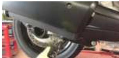
**ITA** Svitare e rimuovere le tre viti di fissaggio al telaio
