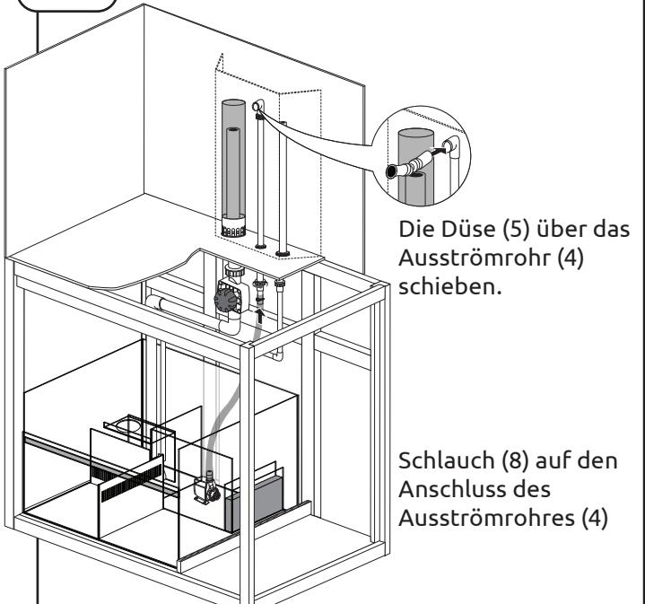
Schlauch (8) auf den Anschluss des Ausströmrohres (4)
