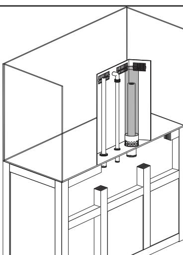
Plaats de doorvoerpip (1), uitstroompip (4) en de overlooppip (6) in de daarvoor bestemde openingen.
