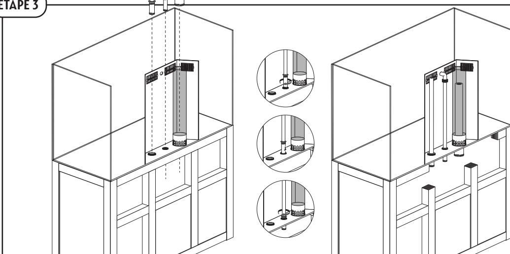
Placez le tube de circulation (1), le tube de refoulement (4) et le tube de débordement (6) dans leur emplacement.
