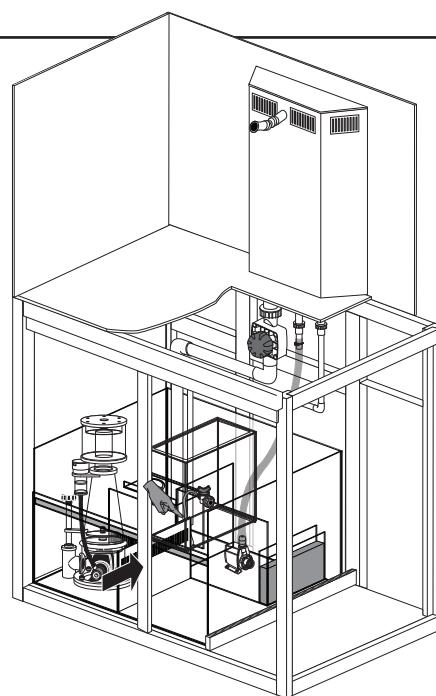
Placez le réservoir d'eau (17) sur le bac à décantation. Connectez le tuyau du réservoir (11) sur le flotteur.
