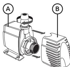
Verwijder de filterkap (B) van de pomp, deze is niet nodig bij een zeeaquarium.
