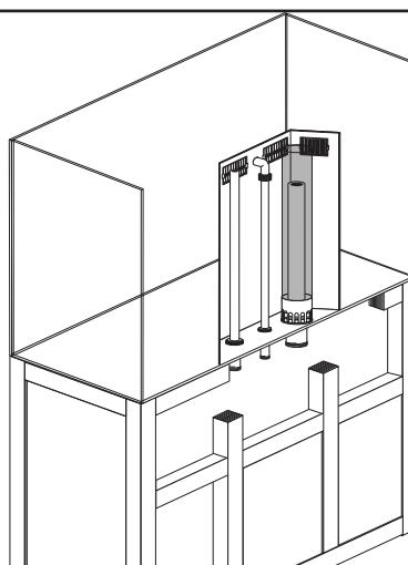
Platzieren Sie das Durchgangsrohr (1), das Ausströmrohr (4) und das Überlaufrohr (6) in die Bohrungen.
