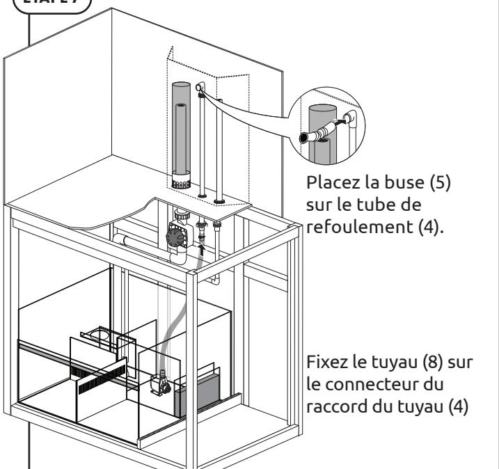
Fixez le tuyau (8) sur le connecteur du raccord du tuyau (4)
