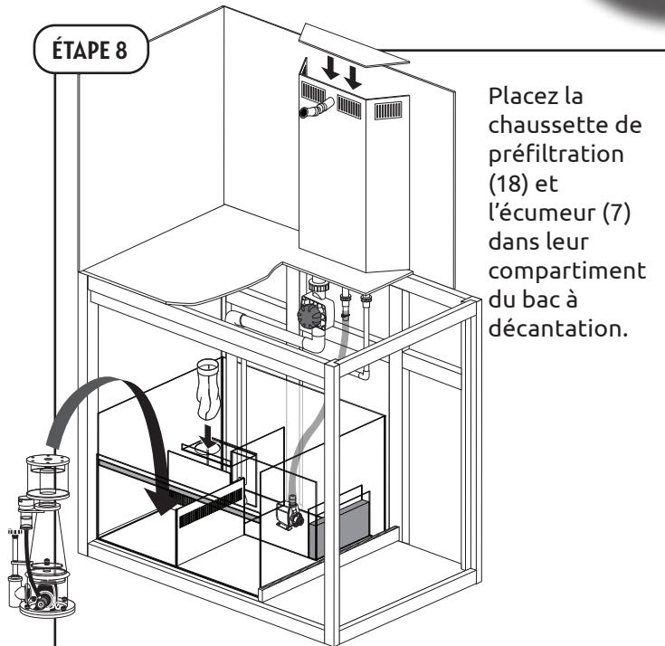
Placez la chaussette de préfiltration (18) et l'écumeur (7) dans leur compartiment du bac à décantation.
