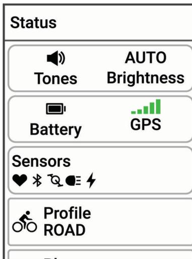
Un'icona lampeggiante indica che il dispositivo sta cercando un segnale. Un'icona fissa indica che il segnale è stato trovato o che il sensore è connesso. Per modificare le impostazioni, selezionare un'icona.
