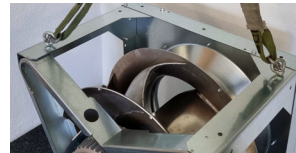
Montage von Hebeösen an dafür vorgesehenen Stellen
