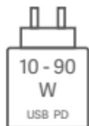
A potência fornecida pelo carregador deve ser entre no mínimo [10] Watts requeridos pelo equipamento de rádio e no máximo [90] Watts para obter a velocidade de carregamento máxima. Carregamento rápido USB PD .
