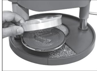
Tourner le support de plaques (11) à l'aide de la poignée (10) vers l'extérieur, enlever la bague de tension et le résultat thermoformé.
