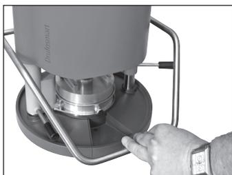
En poussant la poignée (5) encore une fois jusqu'à l'arrêt suspendu pour approx. 3 secondes, la mise en pression aura lieu automatiquement. Il y aura un signal acoustique pour la confirmation.
