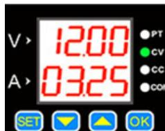
Drücken Sie „OK“ um den Ausgang an und auszu-schalten. Wenn die Laststrom unter dem gesetzten maximal Strom liegt, dann wechselt der Ausgang zum Konstantspannungsmodus und CV leuchtet auf.
