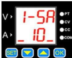
Dieser Menüpunkt deklariert die Limits von Spannung und Strom. Die „10“ bedeutet hier das obere Limit, die „11“ das untere Limit und die „12“ das Löschen der Limits.
