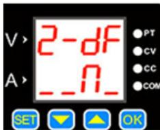
Dieser Menüpunkt ermöglicht das Zurücksetzen des Geräts auf die Werkseinstellungen. Die Auswahl „Y“ führt einen Reset durch, während „N“ die aktuellen Einstellungen beibehält.
