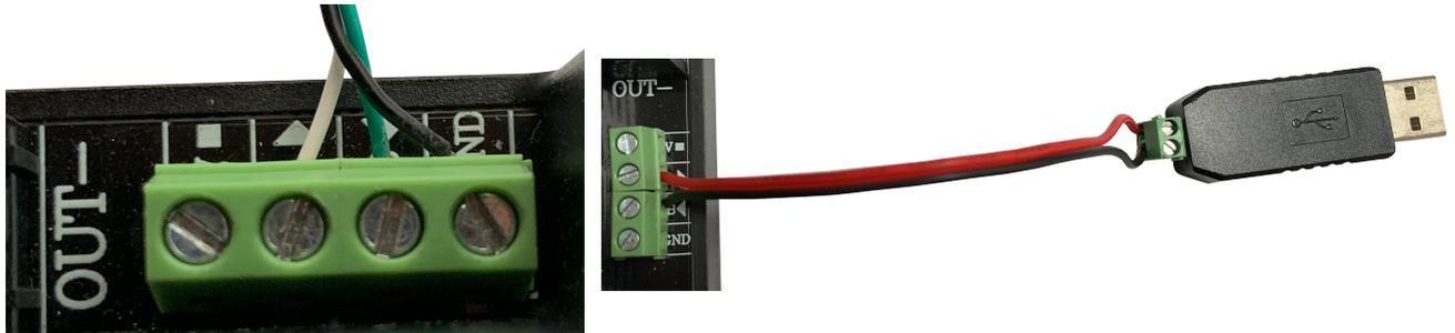
Nachdem die Kabel gemäß den Anweisungen in Bild und Tabelle am Spannungswandler angeschlossen wurden, verbinden Sie das Gerät nun über USB mit dem PC. Überprüfen Sie im Geräte-Manager unter „Anschlüsse (COM & LPT)“, an welchem Port der Wandler angeschlossen ist; in diesem Beispiel wäre es COM4.
