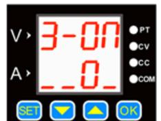
Dieser Menüpunkt dient als Statuschnittstelle. Er ermöglicht die Einstellung, dass beim Hochfahren des Geräts der Ausgang entweder automatisch aktiviert wird (Option „1“) oder manuell aktiviert werden muss (Option „0“).
