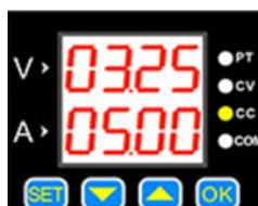
Wenn der Laststrom den gesetzten maximal Strom erreicht, dann ist der Ausgangstrom gleich wie der gesetzte Strom und das Gerät wechselt zu dem Konstantstrom, welches zur Folge hat, dass die CC-LED aufleuchtet.
