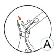
A) En cas de mécanisme de pliage trop lâche ou trop serré, il convient d'ajuster la vis argentée pour le rendre un peu plus haut ou un peu plus court. (Image A)
