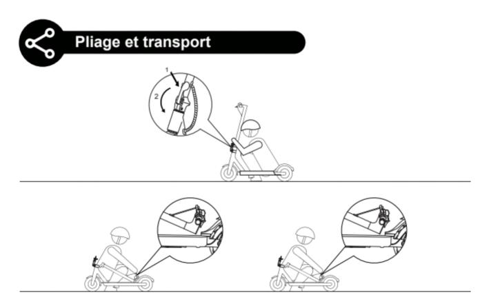
Assurez-vous que le scooter est éteint. Pour plier, déverrouillez le mécanisme de pliage, et pliez la tige du guidon pour accrocher la boucle sur le garde-boue arrière. Pour ouvrir, appuyez sur la gâchette de la cloche pour la retirer de la boucle, redressez le guidon et verrouillez la structure de pliage.
