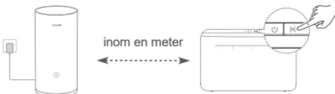
Steg 2: När indikatorn på HUAWEI CPE börjar blinka trycker du på **H**-knappen på enheten. Vänta tills indikatorn på routern visar att routern är ansluten till nätverket.
