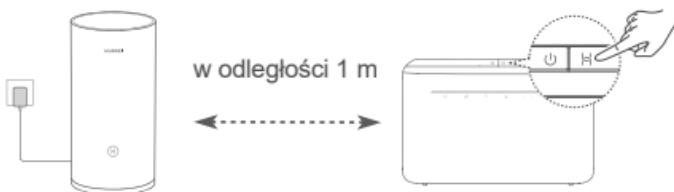
Krok 2: Gdy wskaźnik urządzenia HUAWEI CPE zacznie migać, naciśnij znajdujący się na nim przycisk **H**. Poczekaj, aż wskaźnik routera zasygnalizuje nawiązanie połączenia z siecią.
