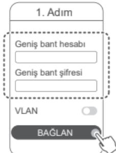
i Ağınızda VLAN'ı yapılandırmanız gerekiyorsa VLAN parametrelerini onaylamak için geniş bant operatörünüz ile iletişime geçin ve ekrandaki VLAN düğmesini etkinleştirin.
