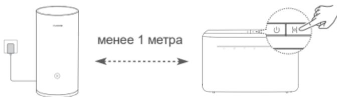
Шаг 2. Когда индикатор на устройстве HUAWEI CPE начнет мигать, нажмите на нем кнопку **H**. Дождитесь, когда индикатор на роутере укажет на то, что роутер подключен к сети.
