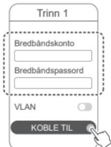
**i** Hvis du har behov for å konfigurere VLAN på nettverket ditt, ta kontakt med bredbåndsleverandøren din for å bekrefte VLAN-parametrerne, og aktiver VLAN-bryteren på skjermen.
