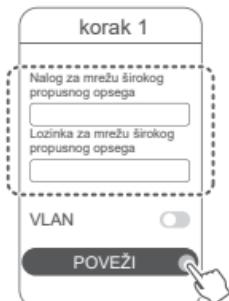
**i** Ako morate da konfigurišete VLAN na svojoj mreži, obratite se mrežnom operateru za mrežu širokog propusnog opsega da biste potvrdili VLAN parametre i omogućite prekidač za VLAN na ekranu.
