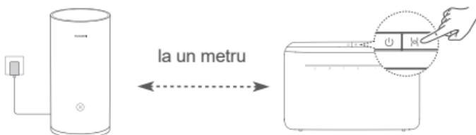
Pasul 2: Când indicatorul de pe HUAWEI CPE începe să lumineze intermitent, apăsați butonul **H** de pe sistem. Așteptați până când indicatorul de pe router arată că acesta este conectat la rețea.
