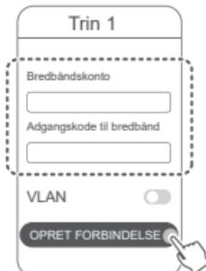
**i** Hvis du har brug for at konfigurere VLAN på dit netværk, skal du kontakte din bredbåndsdudbyder for at bekraefte VLAN-parametrene og aktivere VLAN-kontakten på skærmen.
