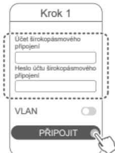
*i* Pokud potřebujete nakonfigurovat síť VLAN ve své síti, obrátěte se na svého poskytovatele širokopásmového připojení, ověřte parametry sítě VLAN a na obrazovce zapněte přepínač VLAN.
