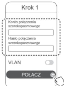
*i* Aby skonfigurować połączenie sieci VLAN w swojej sieci, skontaktuj się z operatorem sieci szerokopasmowej w celu potwierdzenia parametrów sieci VLAN, a następnie włacz przełącznik sieci VLAN na ekranie.
