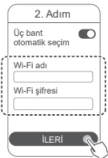
*i* Üç bant otomatik seçim özelliğini etkinleştirin: 2,4 GHz ve 5 GHz Wi-Fi adları aynı olacaktır. Otomatik olarak daha hızlı olan Wi-Fi ağına bağlanılacaktır.
