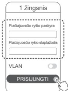
*i* Jei jūsų tinkle reikia sukonfigūruoti VLAN, susisiekite su savo plačiajuosčio ryšio tinklo operatoriumi ir išsiaiškinkite VLAN parametrus, tada ekrane įjunkite VLAN jungiklij.
