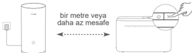
2. Adım: HUAWEI CPE cihazının göstergesi yanıp sönmeye başladığında üzerindeki H düğmesine basın. Yönlendiricinin göstergesi yönlendiricinin ağa bağlılığını gösterene kadar bekleyin.
