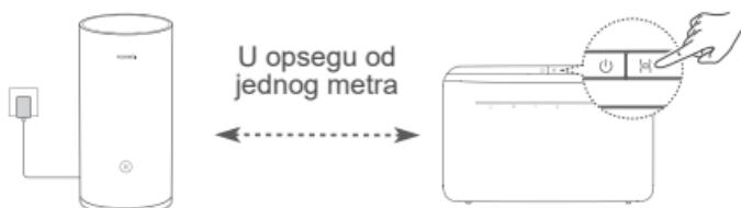
2. korak: kada indikator na HUAWEI CPE uređaju počne da treperi, pritisnite H taster na njemu. Sačekajte da indikator na ruteru pokaže da je ruter povezan na mrežu.
