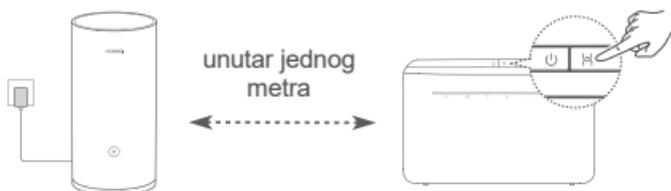
2. korak: kada pokazivač na uređaju HUAWEI CPE počne treperiti, pritisnite tipku **H** koja se nalazi na njemu. Pričekajte da pokazivač na usmjerivaču pokaže da je usmjerivač povezan s mrežom.
