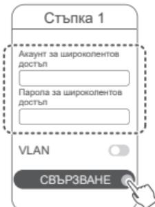
*i* Ако трябва да конфигурирате VLAN достъп на мрежата си, свържете се със своя доставчик, за да получите параметрите за VLAN, след което активирайте превключвателя за VLAN на екрана.
