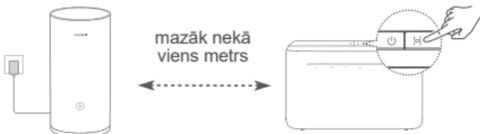
2. darbība: kad sāk mirgot ierīces HUAWEI CPE indikators, nospiediet tās pogu **H**. Uzgaidiet, līdz indikators uz maršrutētāja norāda, ka maršrutētājā ir izveidots savienojums ar tīklu.
