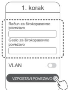
**i** Če morate v omrežju konfigurirati VLAN, se obrnite na svojega ponudnika širokopasovnih storitev, da preverite parametre za VLAN, in omogočite stikalo VLAN na zaslonu.
