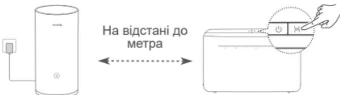
Крок 2. Коли індикатор HUAWEI CPE почне блимати, натисніть на ньому кнопку Н. Дочекайтесь сигналів індикатора, які свідчимуть про підключення маршрутизатора до мережі.
