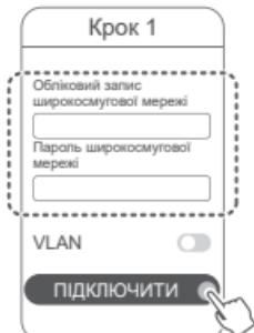
І Якщо вам потрібно налаштувати VLAN (віртуальну локальну мережу), підтвердьте її параметри в оператора широкосмугового доступу й увімкніть перемикач VLAN на екрані.
