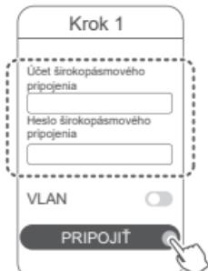
ⓘ Ak potrebujete nakonfigurovať siet' VLAN vo vašej sieti, kontaktujte svojho poskytovateľa širokopásmového pripojenia, aby ste potvrdili parametre siete VLAN a na obrazovke zapnite prepínač siete VLAN.
