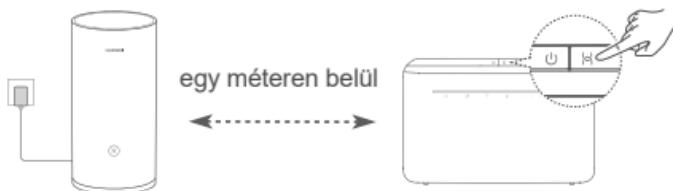
2. lépés: Amikor a HUAWEI CPE készüléken található jelzőfény villogni kezd, nyomja meg rajta a **H** gombot.
