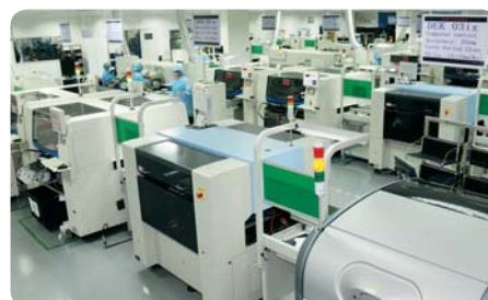
Technologie de pointe de composants de surface permettant d'utiliser des composants miniaturisés installés avec précision et rapidité sur les circuits imprimés
