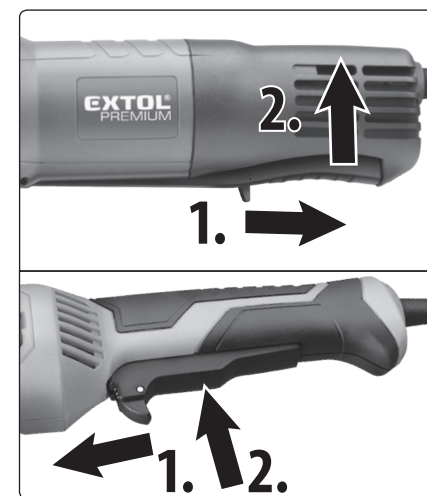
Obr. 15; krok 1. odistenie, krok 2. zapnutie
