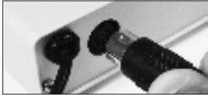
1. Stecken Sie den runden Stecker des Transformator-Netzkaabels in die Rückseite des Scalers, wobei der Pfeil auf dem Stecker nach oben zeigt.
