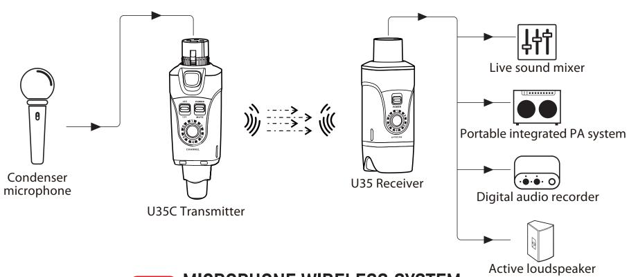
MICROPHONE WIRELESS SYSTEM For Condenser Microphones
