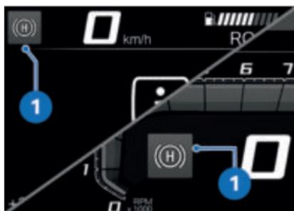
起动辅助的图标 **1** 将在视图 Pure Ride 和上部状态栏中显示。
