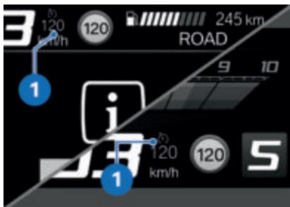
主动控制巡航系统的图标 **1** 将在视图 Pure Ride 和上部状态栏中显示。
