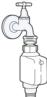
tubo de suministro de seguridad
