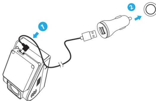
Stecken Sie den USB Adapter in die 12V / 24V Steckdose Ihres Fahrzeugs. Stecken Sie den Stecker des USB-Kabels in den USB-Anschluss der Kamera.
