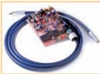
Hier ist ein Projekt, das sich mit einem Audio-D/A-Wandler für optische wie elektrische S/PDIF-Eingangssignale mit integriertem USB-Receiver befasst. Ebenfalls an Bord ist ein PIC-Mikrocontroller zur Steuerung und Bedienung des Ganzen. Herzstück des Projektes bildet der S/PDIF-Receiver CS8416 von Cirrus Logic.
