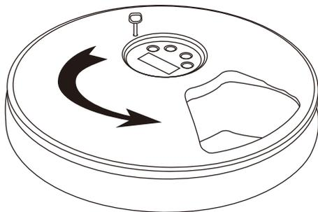
**2** Drehen Sie den Deckel von Hand gegen den Uhrzeigersinn, um die obere Abdeckung zu öffnen.
