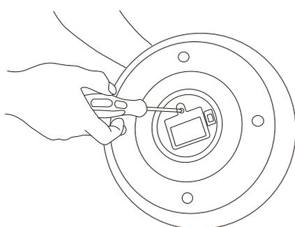
**1** Desenrosca la tapa del compartimento de pilas con un destornillador.
