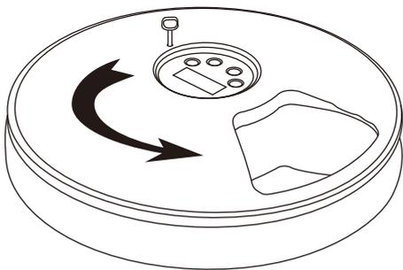
**2** Tournez le couvercle à la main dans le sens inverse des aiguilles d'une montre pour ouvrir le couvercle supérieur.
