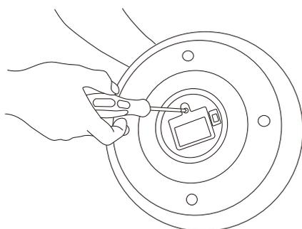
**1** Svitare il coperchio del vano batteria con un cacciavite.
