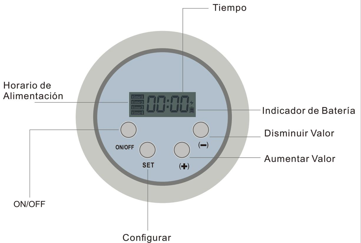
El comedero guarda sus configuraciones personalizadas y utiliza un sistema de reloj de 24 horas, que se divide en 4 tiempos cada 24 horas. La configuración predeterminada: **time1** es 06:00, **time2** es 11:00, **time3** es 16:00, **time4** es 21:00.
