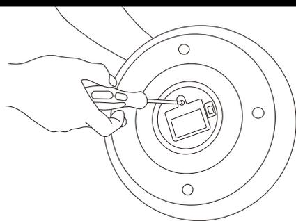
1 Desaperte a tampa do compartimento das pilhas com uma chave de fendas.
