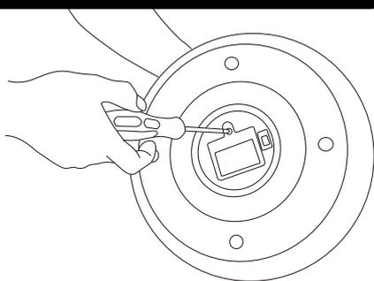
**1** Dévissez le couvercle du compartiment à piles à l'aide d'un tournevis.
