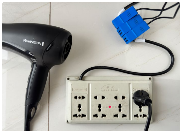
Figuur 7. Opstelling voor het testen en kalibreren van de ESP32-energiemeter met een variabele belasting.
