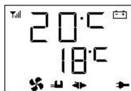
État de mise sous tension (mode automatique)
