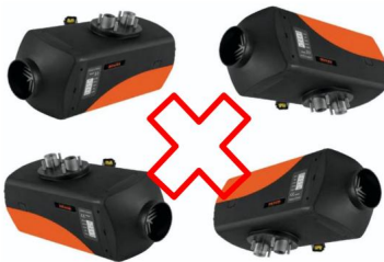
Dirección de instalación incorrecta
