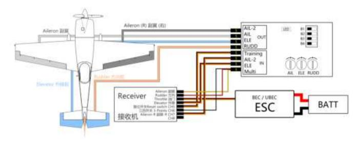
3 通电测试:约5秒后,副翼方向升降三个舵面会较大幅度抖动一次,代表飞控已经启动。
