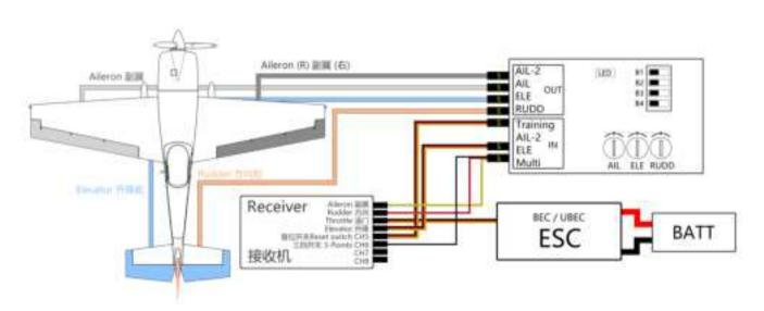
2 左右副翼单独控制 (遥控器需要设置双副翼通道,适用于襟翼副翼混控模式)
