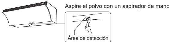
Si el polvo persiste, extraiga la caja del sensor, lave el filtro del sensor y séquelo completamente.
