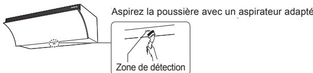
Si la poussière persiste, retirez le boîtier du capteur, lavez le filtre du capteur et séchez-le complètement.
