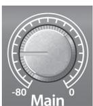
**Main.** La perilla Main controla el nivel de salida para las salidas principales (Main Output) situadas en la parte trasera de AudioBox, dentro de un rango de -80 dB a +0 dB.
