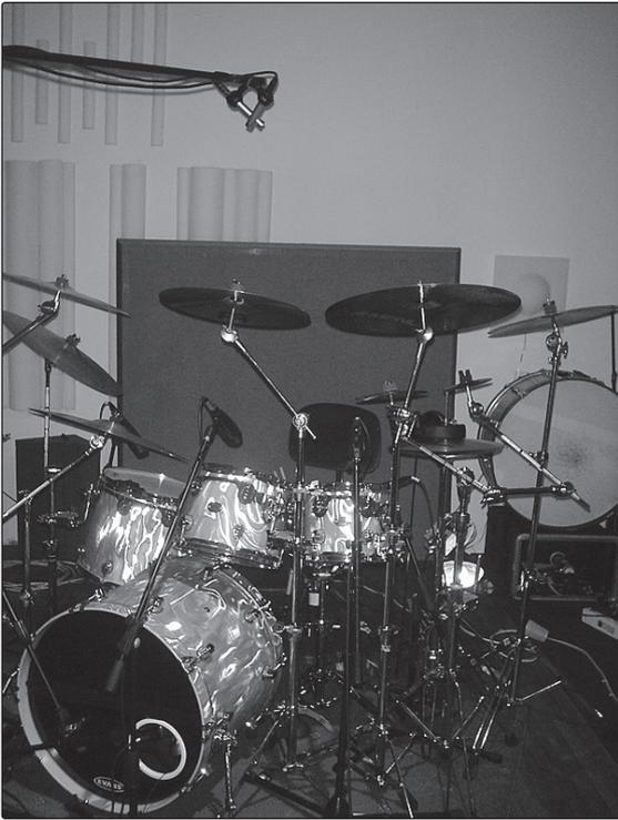
Coloque dos micrófonos condensador de pequeño diafragma en un soporte XY para micrófono estéreo (bar). Fije la posición de los micrófonos para que estén entre sí en un ángulo de 45 grados, apuntando hacia abajo al kit de batería, aproximadamente a una altura de dos a tres metros del piso. Experimente con la altura. Esta técnica se puede aplicar también en vivo.
