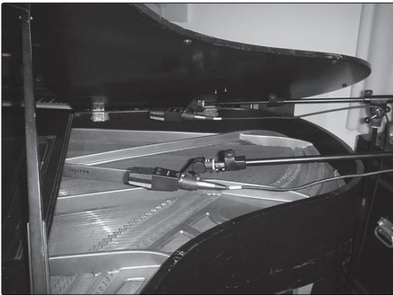
Coloque un micrófono sobre las cuerdas agudas y un micrófono sobre las cuerdas graves. Experimente con la distancia (con el de más atrás, capturará un sonido con más cuerpo). Esta técnica se puede utilizar para aplicaciones de vivo y en estudio.
