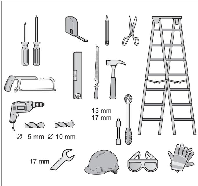
Para realizar el ensamblaje y el montaje del automatismo necesita las herramientas arriba ilustradas. Prepare las herramientas necesarias para garantizar un montaje rápido y seguro.
