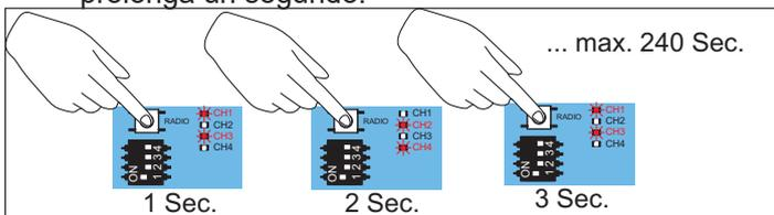
4. Cuente el tiempo de apertura a través de los cambios de encendido de los LED. Cuando se alcance la duración deseada, suelte la tecla RADIO.
