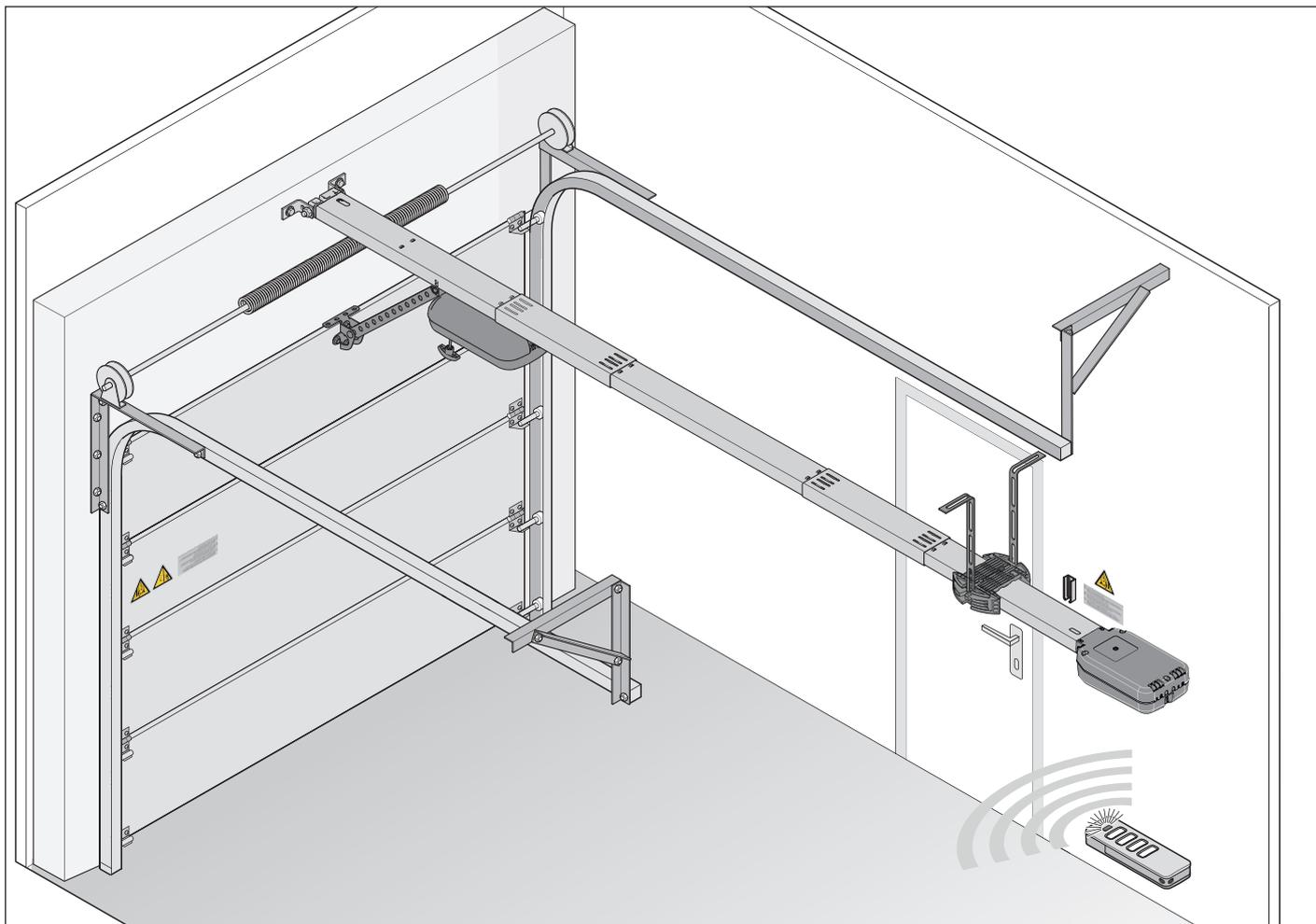
Con el automatismo eléctrico y los accesorios suministrados pueden abrirse y cerrarse puertas seccionales y otro tipo de puertas. El automatismo se controla, por ejemplo, a través de un emisor.
