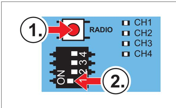
3. **Pulse y mantenga pulsada** primero la tecla RADIO. Mientras tanto, coloque el interruptor DIP 1 en la posición "ON".
