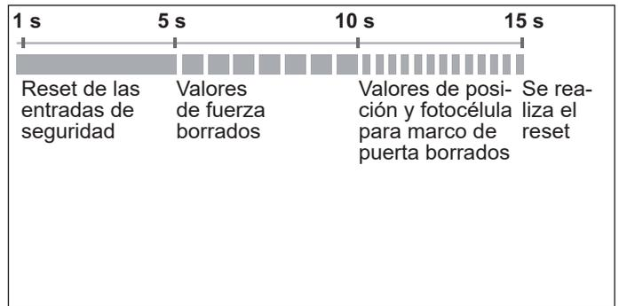
Fig. Sinopsis de la secuencia de tiempo del LED de estado (Status) en el carro
