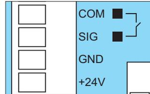
Borne de conexión para fotocélula de 4 hilos
