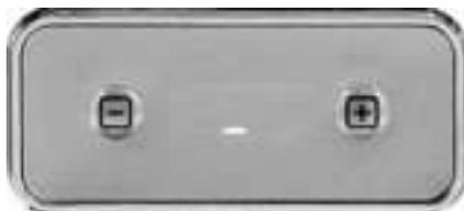
Stellen Sie sicher, dass sich der Strich auf dem Display in der Mitte befindet.
