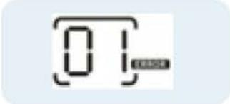
.....> **Fallo del ventilador** .....> 1. Reemplace el ventilador
