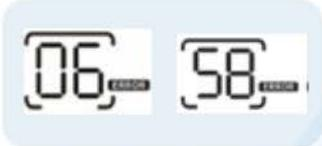
.....> **Salida anormal (voltaje del inversor inferior a 190 VCA o es superior a 260 VCA)** .....> 1. Reducir la carga conectada
