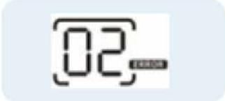
.....> **La temperatura interna del inversor es superior a 100 °C** .....> 1. Compruebe si las rejillas de los ventiladores están tapadas o si la temperatura ambiente es demasiado alta
