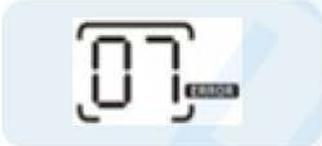
.....> **El inversor tiene una sobrecarga del 110%** .....> 1. Reduzca la carga conectada
