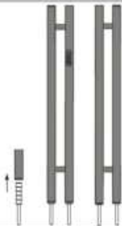
Stap 3: Markeer de positie van de montagegaten met de sjabloon voor het plaatsen van de gaten.
