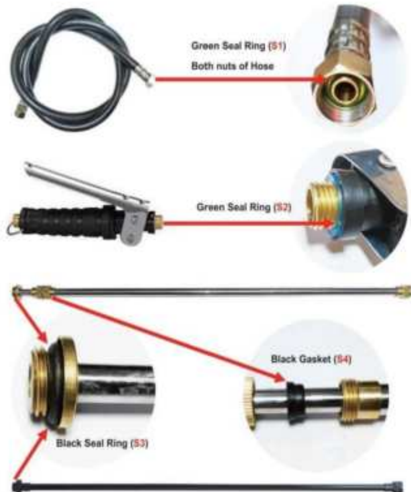
Anello di tenuta verde (S2) 11X17X3 (installato)
