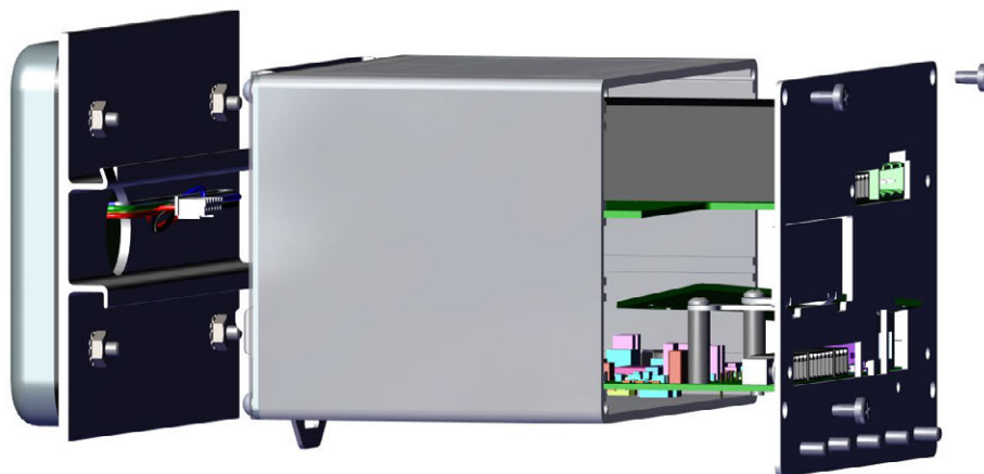
Figura 2-9. Desmontaje de la placa posterior del conjunto del controlador
