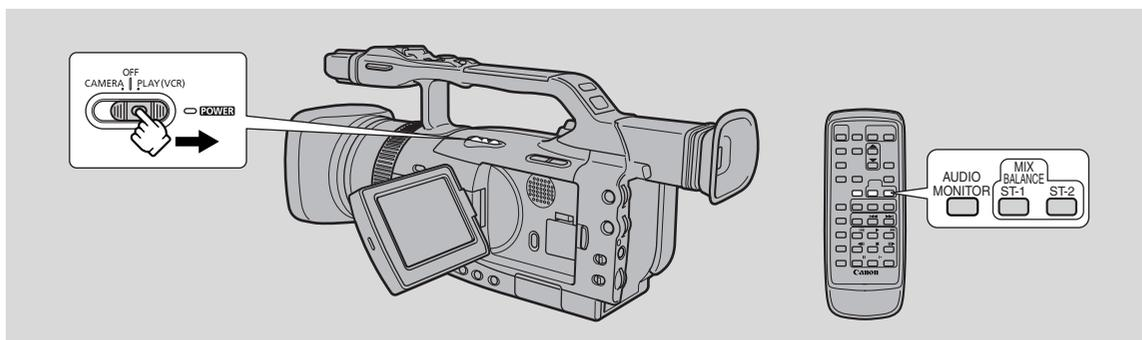
Cuando reproduzca una cinta grabada en el modo de 12- bits, podrá ajustar la salida de audio para reproducción: estéreo 1 (el sonido original), estéreo 2 (cualquier sonido nuevo, copiado en la cinta después de la grabación), o mezclar el balance entre ambos.
