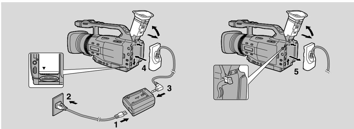
Utilice el adaptador de alimentación y el acoplador de CC para suministrarle alimentación instantánea a su videocámara desde un tomacorriente de alimentación del hogar.
