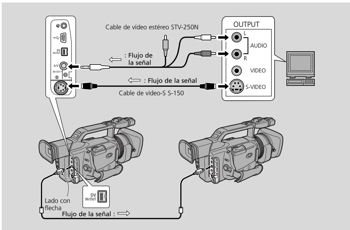
La ilustración de arriba muestra la conexión utilizando un cable de vídeo-S. En su lugar, también puede conectar la clavija amarilla al terminal VIDEO.
