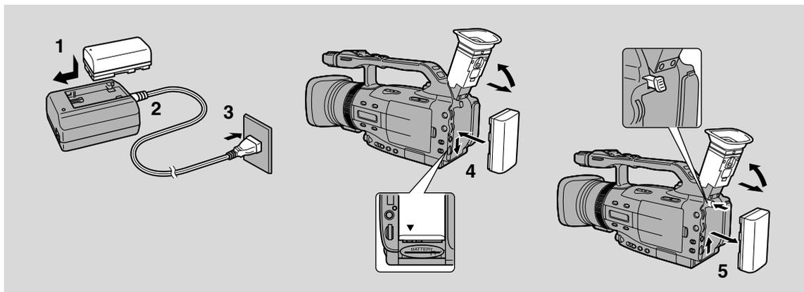
La batería ha sido cargada parcialmente antes de salir de fábrica. Estará cargada lo suficiente como para que pueda verificar el buen funcionamiento de la videocámara. Sin embargo, si desea que alimente a la videocámara durante más de algunos minutos, cárguela por completo.
