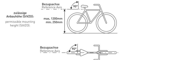
**i** Überprüfen Sie regelmäßig die richtige Einstellung und Anbauhöhe Ihres Rücklichtes. Das Rücklicht muss in einem Bereich von 250 bis 1200 mm über der Fahrbahn montiert werden. Es muss so angebaut und eingestellt werden, dass die Bezugsachse parallel zur Fahrzeuglängsmittellebene und parallel zur Fahrbahn liegt (siehe Abbildung).
