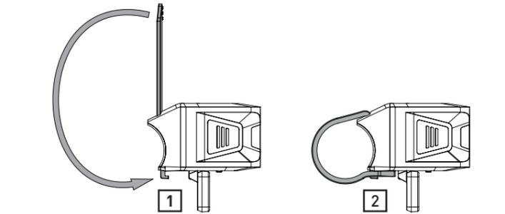
Rücklicht - Montage an Sattelstütze | Rear Light - Mounting On Seat Post
