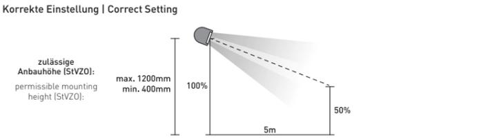
**i** **WICHTIG!** Stellen Sie den Lichtkegel des Scheinwerfers so ein, dass die Mitte des Lichtkegels in 5 m halb so hoch ist wie der Scheinwerfer selbst.
