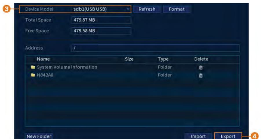
3. Sous **Device Model**, sélectionnez le dispositif USB où vous voulez enregistrer la configuration.
