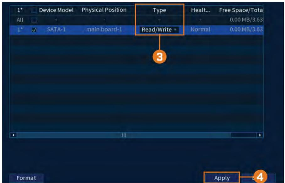
3. Sélectionnez le type de disque dur sous la colonne **Type** à côté du disque dur que vous souhaitez configurer.
