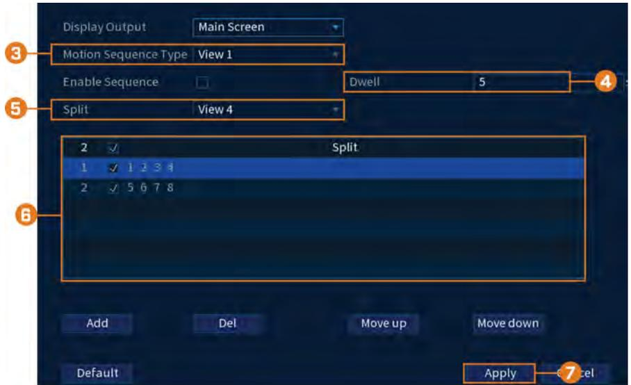
3. Choisissez le nombre de canaux qui apparaîtront à l'écran lorsque le mode Séquence est déclenché par la détection de mouvement (vous devez cocher la case **Sequence** lorsque vous configurez la détection de mouvement — voir 12 *Détection de mouvement*, page 41 pour plus de détails).
