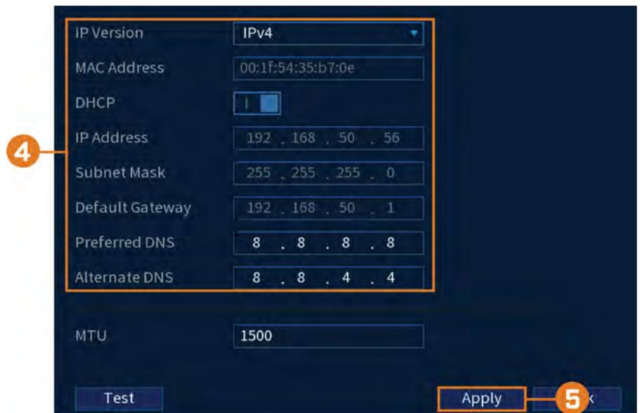
3. Cochez la case **DHCP** (conseillé) pour permettre au système d'obtenir automatiquement une adresse IP du routeur.
