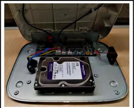
6. Soulevez soigneusement le panneau inférieur avec le disque dur, en tenant compte des arêtes vives du panneau inférieur. Glissez les 2 vis préinsérées en position verrouillée, puis serrez les vis. Insérez et serrez les 2 vis restantes du disque dur.
