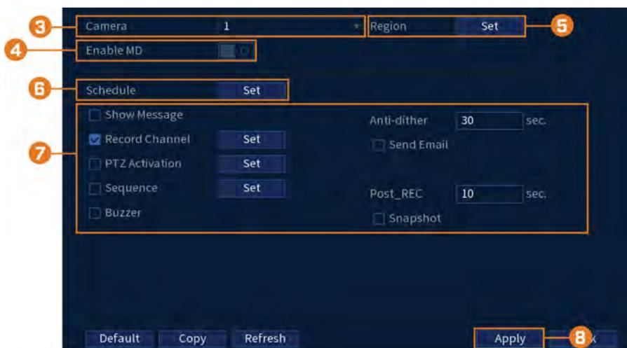
3. Sélectionnez un canal pour configurer la détection de mouvement pour.
