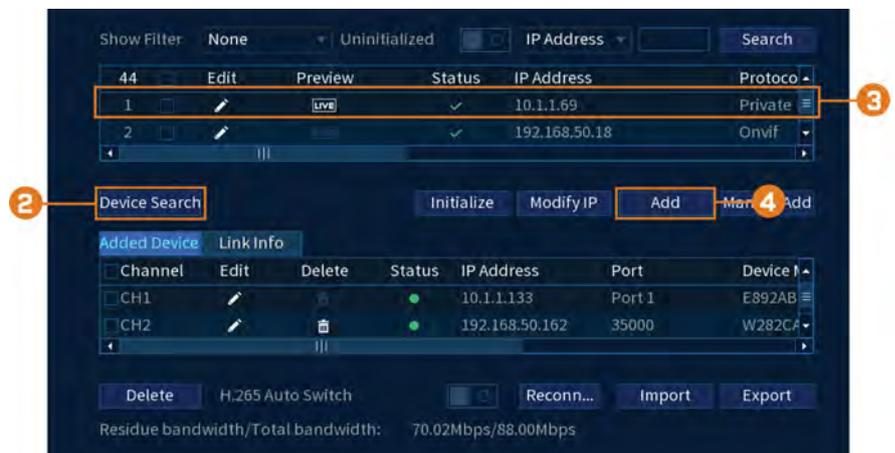
2. Cliquer sur **Device Search**. Le système cherche les caméras prises en charge sur le réseau.
