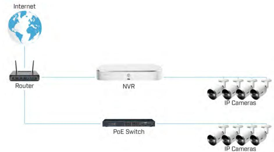
1. Branchez un câble Ethernet du port LAN sur un commutateur externe PoE (vendu séparément sur [lorex.com](http://lorex.com)) à votre routeur en utilisant un câble CAT5e ou un câble Ethernet de meilleure qualité. Connectez le câble d'alimentation à l'interrupteur PoE et branchez-le à la prise de courant ou au limiteur de surtension.
