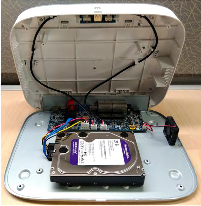
5. Alignez les 2 vis à moitié insérées du disque dur avec les 2 trous indiqués ci-dessous.
