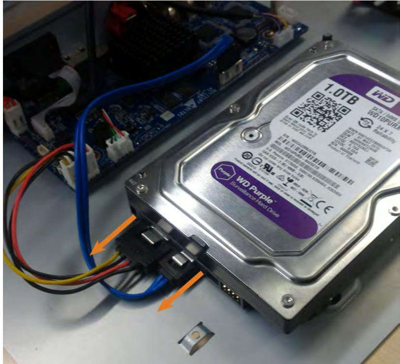
5. Prenez soigneusement le disque dur pour soulever le panneau inférieur, en tenant compte des arêtes vives du panneau inférieur. Retirez les vis (4x) du panneau inférieur. Tenez le disque dur de manière à ce qu'il reste en place une fois que toutes les vis ont été retirées.
