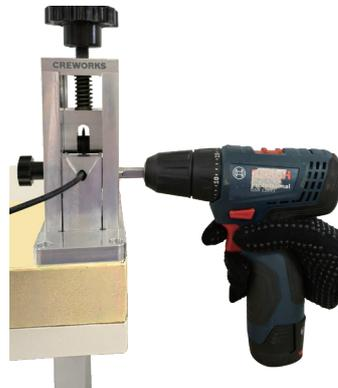
Wenn die Isolierung des Drahts nicht abgezogen wird, unterbrechen Sie die Arbeit, heben Sie die Klinge an, entfernen Sie den Draht und senken Sie die Klinge weiter ab, bevor Sie erneut beginnen.
