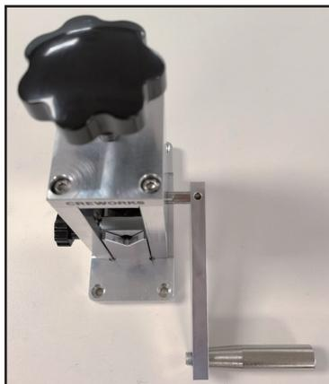
Alternativ können Sie den Griff durch einen Schlagschrauber und eine Sechskant-Stecknuss von 9 mm (nicht im Lieferumfang enthalten) ersetzen.
