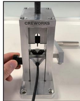
3. Führen Sie den Draht ein und senken Sie dann die Klinge ab, indem Sie den Einstellknopf im Uhrzeigersinn drehen, bis Sie spüren, dass die Klinge den Draht berührt.
