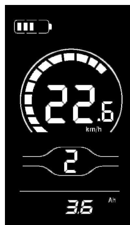
5-6 Motor teljesítményjelző interfész
