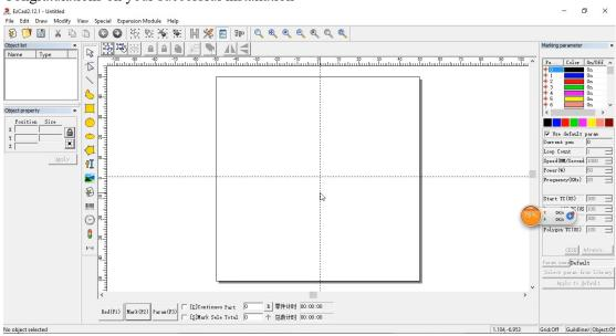
如果提示 Can not find dongle! Software will work at demo state. 说明您没有安装驱动或者打标机未打开,或者电脑与打标机用 USB 线没有连接.
