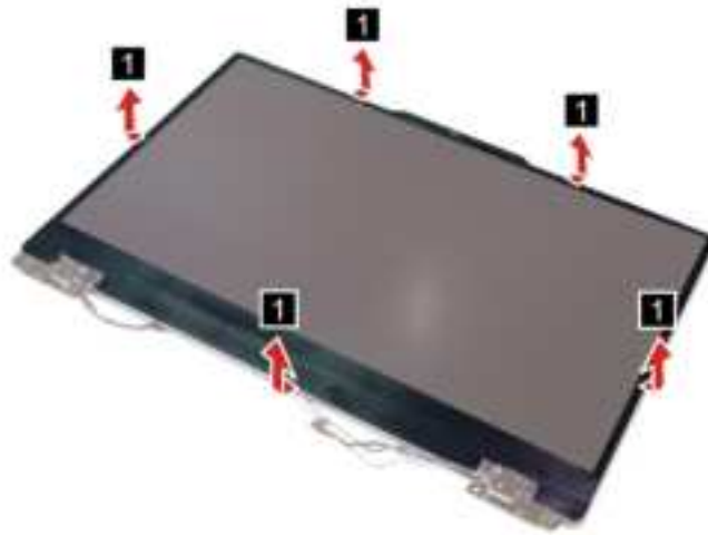
Figure 27. Remove the LCD bezel
