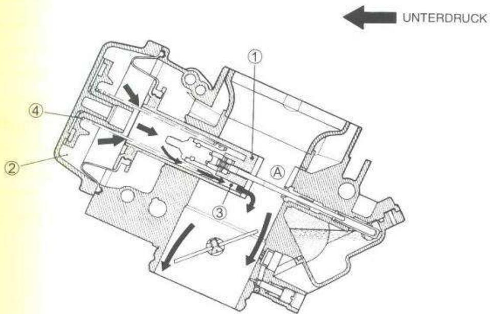
UNTERE POSITION DES KOLBENSCHIEBERS
