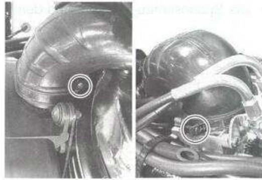
Den Lüftungsschlauch abtrennen.
