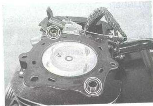
Den Zylinderkopf anbringen, und die Zylinderkopfschrauben überkreuz auf das vorgeschriebene Anzugsdrehmoment anziehen. (Hinterer Zylinder)
