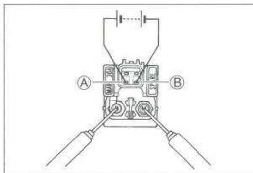
Den Relaispulenwiderstand zwischen den Klemmen mit dem Multi-Stromkreistester messen. Wenn der Widerstand nicht vorschriftsgemäß ist, das Starterrelais durch ein neues ersetzen.
