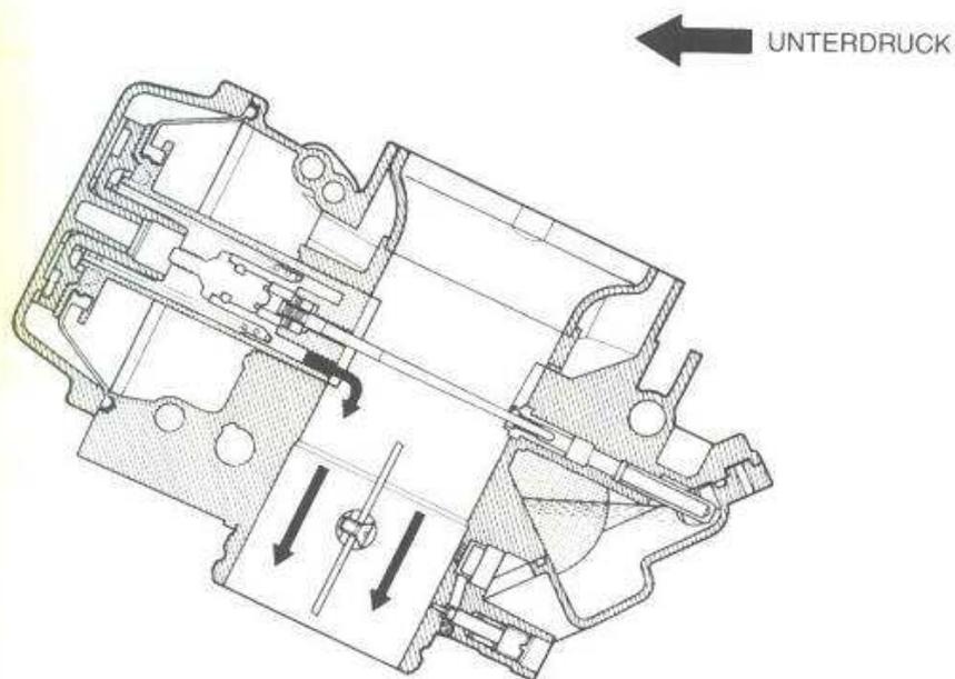
OBERE POSITION DES KOLBENSCHIEBERS
