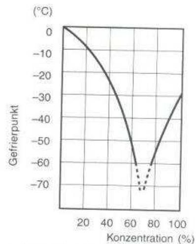
Abb. 1 Kühlmittel-Dichte/Gefrierpunktkurve.
