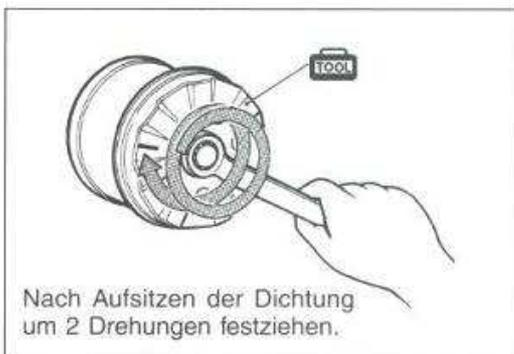
Nach Aufsitzen der Dichtung um 2 Drehungen festziehen.
