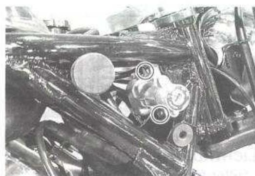
Jeden Schalter mit einem Tester auf Stromdurchgang überprüfen. Falls irgendeine Ungewöhnlichkeit festgestellt wird, die entsprechenden Schalter-Baugruppen durch neue ersetzen.
