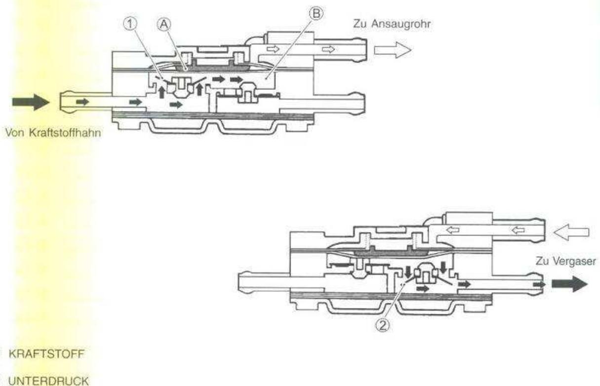
Wenn der Kraftstoffdruck in der Kammer der Vergaserseite zu hoch ist, wird das Rücklaufventil ③ geöffnet, so daß der Kraftstoffdruck zur Kammer der Kraftstoffhahnseite hin entlastet wird.
