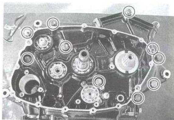
Das Kurbelgehäuse mit dem Spezialwerkzeug in zwei Teile trennen.
