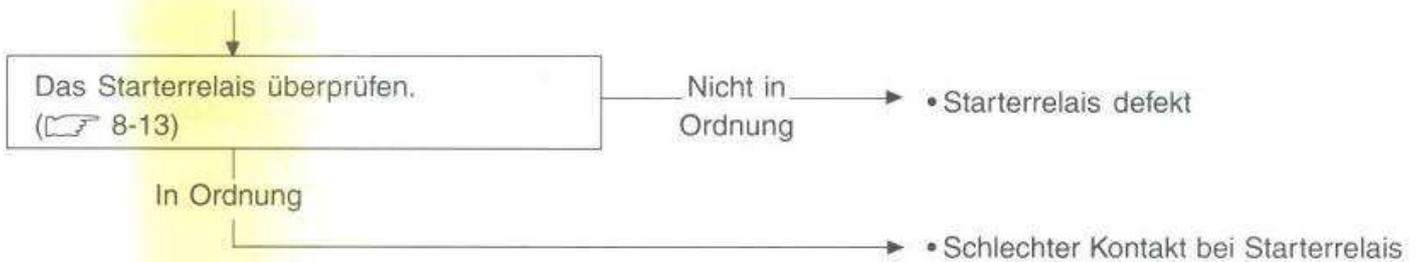
Der Starter läuft, wenn das Getriebe auf Leerlauf geschaltet ist, jedoch bei eingeklapptem Seitenständer in keiner anderen Schaltposition.
