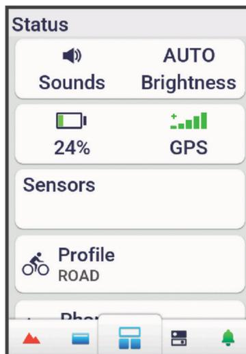
O widget de status é exibido. O ícone intermitente significa que o dispositivo está procurando sinal. Um ícone sólido significa que o sinal foi encontrado ou sensor está conectado. Você pode selecionar qualquer ícone para alterar as configurações.
