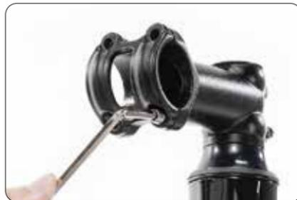
5. Setzen Sie den Lenker in die Klemme ein, setzen Sie die Abdeckplatte über die Vorderseite des Lenkers und ziehen Sie die Schrauben kreuzförmig fest an.
