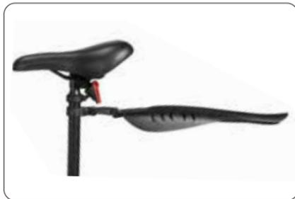
3. Öffnen Sie den Hebel der Sattelstützenklemme, setzen Sie die Sattelstütze in das Sattelrohr ein und ziehen Sie die Sattelstützenklemme fest an.
