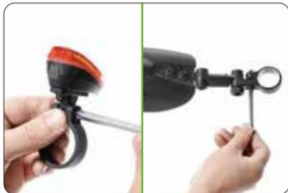
2. Die Sattelstütze naheinander in die Klemmen von Rücklicht und Schutzblech einschieben.
