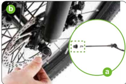
4. Setzen Sie die Kegelfeder wieder ein, ziehen Sie die Hutmutter fest und schließen Sie den Schnellspannhebel (senkrecht vor der Gabelscheide, nicht dahinter).
