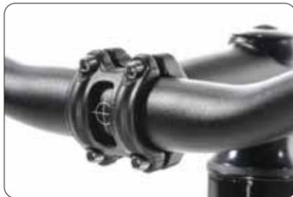
7. Stellen Sie nach der Montage des Lenkers den gewünschten Winkel für Schalthebel und Bremshebel ein und ziehen Sie die Schrauben fest.
