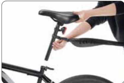
4. Stellen Sie Rücklicht und hinteres Schutzblech auf die gewünschte Höhe und den gewünschten Winkel ein und ziehen Sie die Schrauben fest an.
