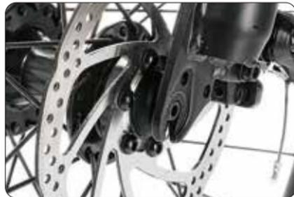
3. Entfernen Sie die Kegelmutter und die Hutfeder vom Schnellspanner und führen Sie den Schnellspanner durch die Vorderradnabe.
