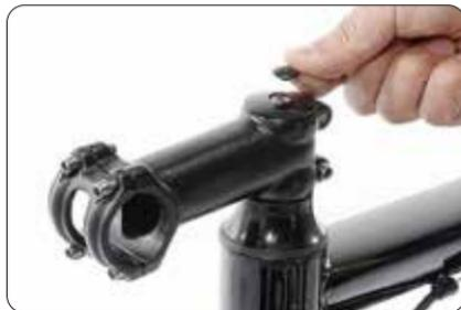
4. Entfernen Sie die Blende der Lenkerklemmung, nachdem Sie die vier Blendenschrauben entfernt haben.
