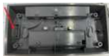
Fissare il nucleo in ferrite sull'alloggiamento
