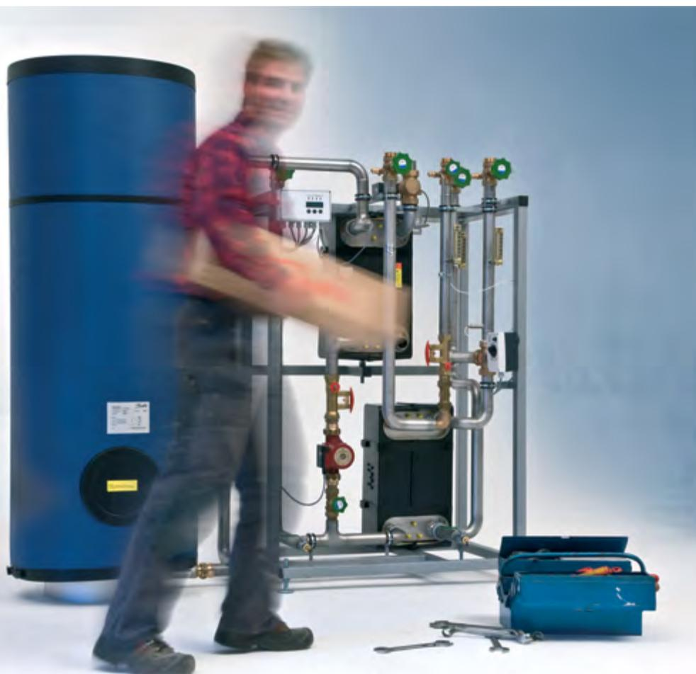
Durchflusswassererwärmer sorgen jederzeit sofort für warmes Trinkwasser aber nur dann, wenn es tatsächlich gebraucht wird. Beim Öffnen einer Zapfstelle, fließt kaltes Trinkwasser durch ein Rohr in den Plattenwärmeübertrager des Gerätes. Hier wird das kalte Trinkwasser durch Heizwasser eines Solar-, Biomasse- oder eines anderen wasserbasierten Heizsystems erwärmt, mit dem Ergebnis einer kontinuierlichen Trinkwarmwasser-Versorgung.
