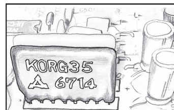
Figure 6 : Circuit imprimé du générateur de son du PS-3300, sur lequel le KORG35 était monté
