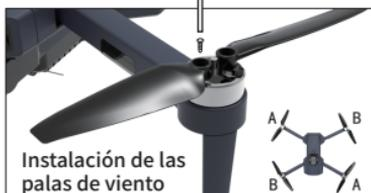
2. Alinee la aleta con el orificio del tornillo del motor cerca del centro (la marca del brazo y la aleta deben coincidir) y apriete el tornillo en el sentido de las agujas del reloj (como se muestra en la imagen)
