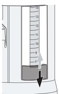
1 b. Prostornino delnega splakovanja nastavite tako, da dvignite ali spusnite beli upogibni plavajoči pokrov. Ko je plovec višje, je količina izpustne vode manjša. Za nastavitev prave količine vode za delno splakovanje se mora pri spuščanju vode ustvariti vrtinec.
