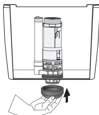
5a. Vstavite tesnilo med kotličkom in školjko na spodnji del izhoda ventila za splakovanje.
