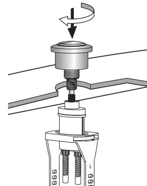
3c. Namestite pokrov kotlička privijte nosilec tipke v navoj okvirja. Preverite in zagotovite, da je funkcija tipke normalna brez kakršnih kolitežav.
