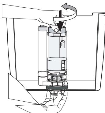
4a. Odtočni ventil namjestite u vodokotlić i pričvrstite zatezanjem u smjeru kazaljke na satu kako je prikazano na slici.
