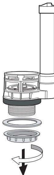
2a. Odstranite matico in objemko iz ogrodja izpustnega ventila. Ne odstranjujte tesnila!!!
