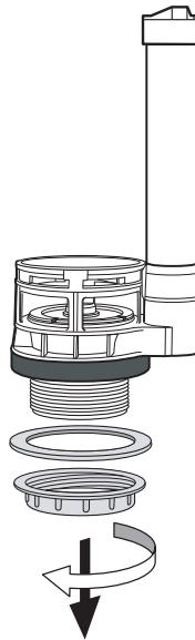
2a. Uklonite heksagonalnu maticu i PVC brtvu od odtočnog ventila. Gumenu brtvu ne mičite.
