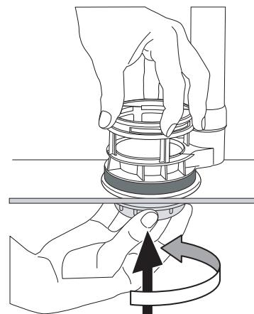
3a. Namjestite odtočni ventil u vodokotlić. Pričvrstite sa heksagonalnom maticom i brtvom.
