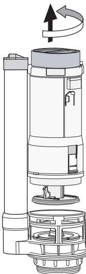
1a. Držite tijelo odtočnog ventila i gornji dio rotirajte u smjeru kazaljke na satu.
