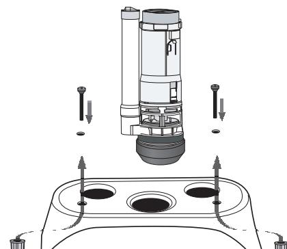
6a. Položite vodokotlić na školjku. Pripazite da gumena brtva sjeda na vodokotlić pravilno. Pričvrstite vodokotlić za školjku sa vijcima koje ste dobili u setu. Pripazite da ispod vijaka postavite gumenu podlošku. Uskladite poziciju vodokotlića na školjki te pričvrstite pomoću vijaka.
