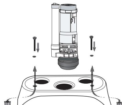
6a. Vzemite kotliček za vodo, ga položite na podstavek in postavite na školjko. Preverite, da je tesnilo v utoru. Rezervoar pritrdite na školjko z enim parom plastičnih ali nerjavnih vijakov. Zagotovite, da imajo vijaki črno gumijasto podložko pod glavo vijaka. Poravnajte luknje med kotličkom in školjko. Vstavite vijake v luknje med kotličkom in školjko. Namestite podložke na vijake in privijte matice.
