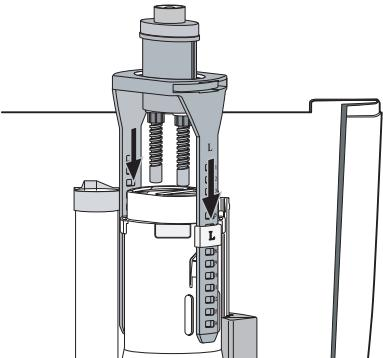
1c. Držite tijelo odtočnog ventila i gornji dio rotirajte u smjeru kazaljke na satu.
