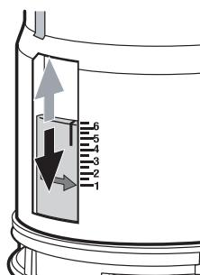
2b. Prilagodite volumen vode za ispiranje pomičući zeleni gumb gore-dolje. Kada je namješteno na veći broj volumen vode je manji i ispiranje kraće. Pomičite zeleni gumb malo po malo do potrebnog volumena da očisti školjku.
