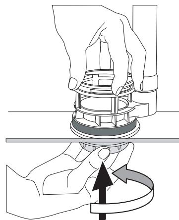
3a. Vstavite podstavek ventila v kotliček za vodo. Pravilno privijte matico in podložko.
