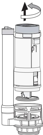
1a. Držite podstavek izpustnega ventila in zavrtite v nasprotni smeri urinega kazalca. Vzemite s podstavka.
