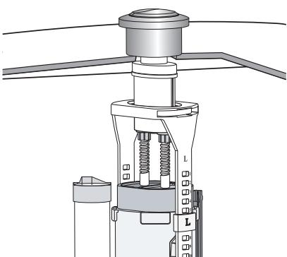
3c. Poklopite vodokotlić i vratite tipku na ventil. Provjerite da li tipka radi ispravno.
