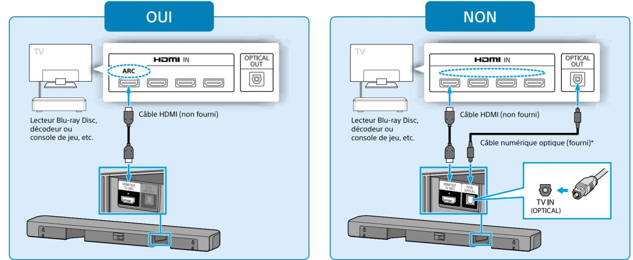
\* Si votre téléviseur ne prend pas en charge la fonction ARC (Audio Return Channel), connectez un câble numérique optique (fourni) pour écouter le son du téléviseur.
